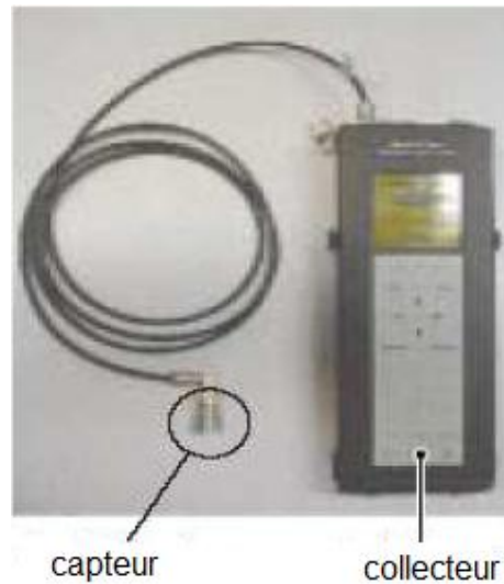
Figure. IV.1 : Capteur de vibration.
